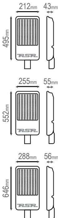
El Cabezal Vial ha sido diseñado para ofrecer la alta funcionalidad y eficiencia de la tecnología led en la sustitución de los faroles viales tradicionales de lampara de descarga. Fabricado en aluminio y cristal, con factor IP65, resiste la corrosión y los rayos UV por lo que se une al bajo consumo la durabilidad y un bajo mantenimiento. Calidad, sostenibilidad y reducción de emisiones de CO2.
