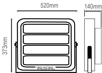
Proyector modular de alta potencia con una eficiencia lumínica de hasta 135lm/w y un ángulo de apertura de 120°.
