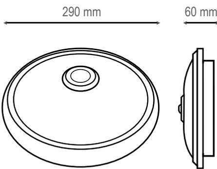
Solución integrada de iluminación y detector de movimiento para el apagado y encendido que unido a la eficiencia del led supondrá una importante reducción del consumo.
