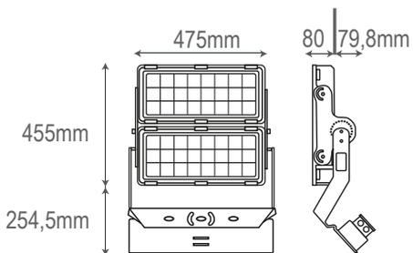
Diseño robusto, liviano, modular, fácil de instalar. Protege la electrónica y el cableado, Especialmente útil en aplicaciones deportivas, que requieren una iluminación precisa, donde sus módulos individuales se pueden ajustar en ángulo según sea necesario. Su ángulo de apertura se puede ajustar en posiciones simétricas de 30°, 60°, 90°, 130° o asimétricas 90°x120° a 40°x130°
