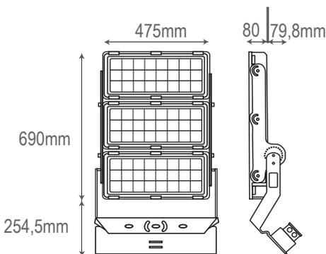
Hermético al polvo y lluvia. Múltiples opciones del ángulo de haz luminoso, incluyendo un ángulo estrecho de 15°. Reemplazo de módulos independientes. Lo que minimizará los costes de mantenimiento. Protección contra circuito abierto, sobrevoltaje y cortocircuito. Soporta una tensión de entrada de hasta 3.750 kilovoltios de corriente alterna. Sin parpadeo.
